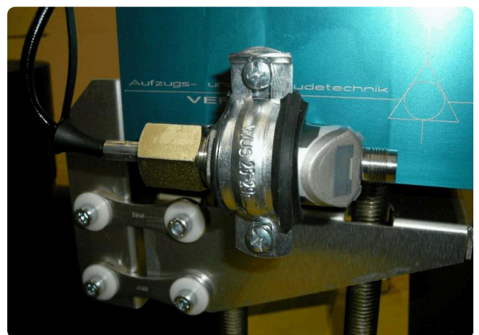
MiniMess 접속부에 연결된 과부하 검출 장치
